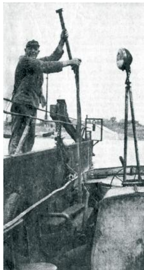
Laut Zeitzeuge tuckerte der Dieselmotor des angebundenen Motorbootes den ganzen Tag. Mit einer Verlängerung wurde von Bord der Fähre aus lediglich aus dem Leerlauf in den Vor- oder Rückwärtsgang geschaltet. Fährmann Jakob Jansen steht am Schalthebel. Aufnahme vom September 1963. (RP-Foto: Getlinger)
