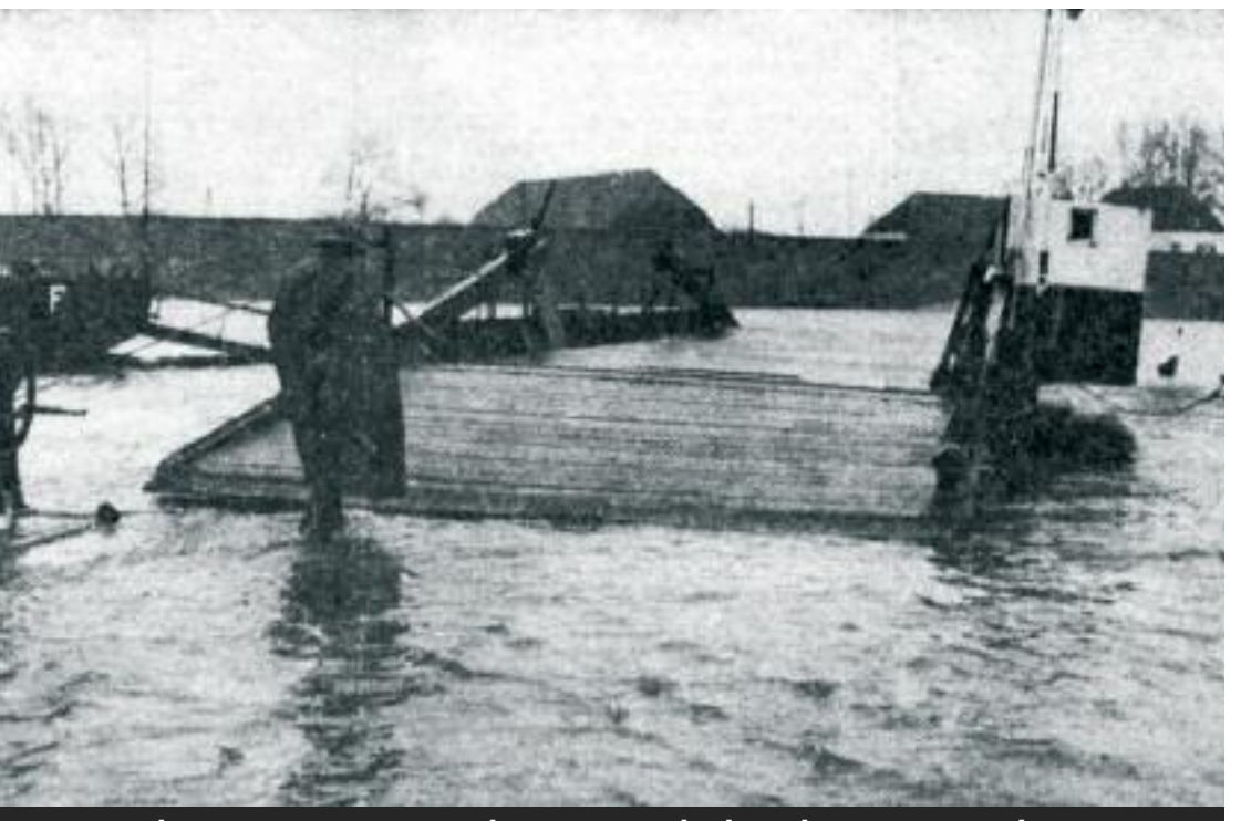
Bei Hochwasser musste das Zugseil abgelassen werden, wenn die Fähre am Ende des Zugseiles angekommen war und dort vor Anker ging. Dann wurde das Motorboot von der Fähre gelöst und als Personenfähreboot eingesetzt. Zeitungsfoto vom Dezember 1966.
